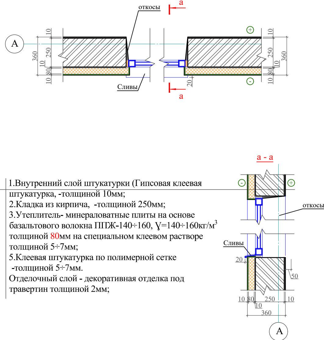
Фрагмент №1 Фрагмент наружных стен
